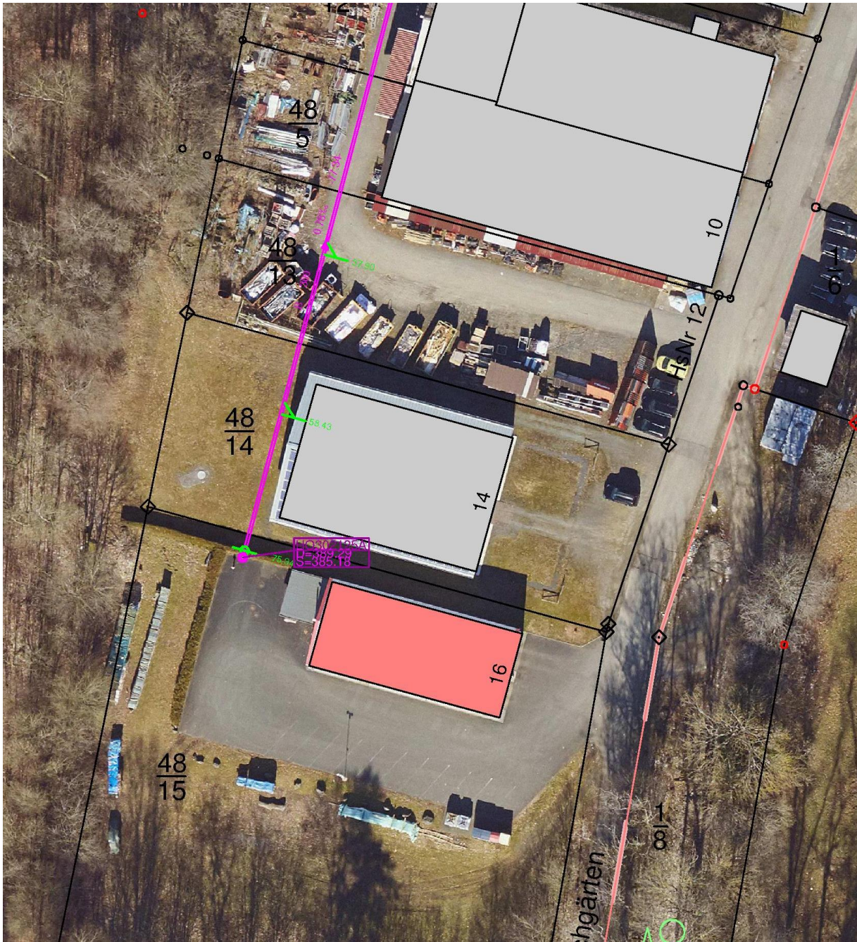
Abbildung 32: Bestand der öffentlichen Kanalisation, westlich der bebauten Grundstücke gelegen (siehe rosafarbene Linie)
